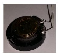
Nachdem der Lautsprecher mit dem Print verbunden ist, bitte mit einem Messgerät überprüfen, ob der LS ca 8  $\Omega$  besitzt. Funktioniert der LS immer noch, ist dieser mit einem Punkt Sekundenkleber auf dem Print zu fixieren. Anschliessend den EIN-AUS Schalter montieren und verlöten.
