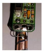
Anschliessend muss noch der Reissnagel und die Kupferfolie mit dem Print verbunden werden. Dazu eignet sich ebenfalls dünner Draht oder Abschnitte von den Bauteilen.
