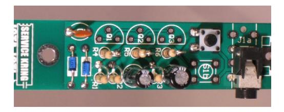
Die beiden nächsten Bauteile sind Elektrolytkondensatoren, kurz "Elko" genannt. Diese müssen polrichtig eingebaut werden. Die Seite mit dem weissen Strich ist der Minuspol (–), der Pluspol (+) ist jener mit dem längeren Draht.
