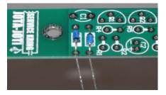
Als nächstes werden die Widerstände montiert. Diese werden senkrecht eingelötet. Dazu wird ein Draht um 180 Grad nach hinten gebogen und die Drähte durch die Löcher gesteckt. Achte dabei, dass sich der Widerstand an jener Stelle mit dem Kreis befindet.
