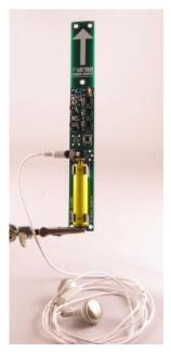
Lege eine Batterie (AAA 1,5 V) in die Klemme und stecke den Kopfhörer in die Klinkenbuchse. Der Signal-Finder ist jetzt einsatzbereit! Der Druckschalter schaltet das Gerät ein. Lausche den Klängen eines Handys, Femsehgerätes oder eines elektrischen Licht... Viel Spass!
