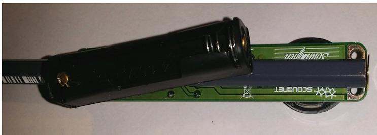
Jetzt kann die Leiterplatte und der Bleistift mithilfe des Batteriefaches verbunden werden.
