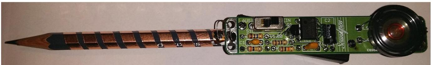
Jetzt sind die Bauarbeiten abgeschlossen. Batterie einsetzen und Spass haben. Dazu den Bleistift in die eine Hand nehmen und einen dicken Strich zeichnen. Der Spitz des Bleistiftes an das eine Ende setzen und mit der anderen Hand das andere Ende des Strichs berühren. Durch verschieben der einen Hand auf dem Strich ändert sich die Tonlage des Sounds...
