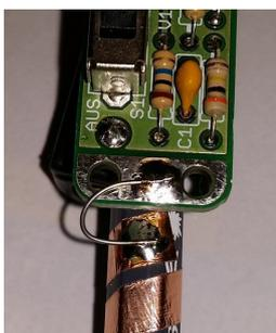
Anschliessend muss noch der Reissnagel und die Kupferfolie jeweils mit der Leiterplatte verbunden werden. Dazu eignet sich ebenfalls dünner Draht.
