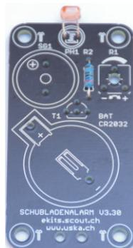
Als nächstes wird der LDR eingebaut. Er hat zwei lange Drähte und besitzt oben eine Art Schlangenmuster. Nach dem löten schneidest du die zu langen Drähte auf der Rückseite ebenfalls ab. Je nach Anwendung kannst du den LDR flach wie auf dem Bild links oder gebogen wie auf dem Bild rechts einbauen. Der Alarm reagiert je nach Einbaulage des LDR bei Licht von oben (flach) oder bei Licht von der Seite (gebogen).
