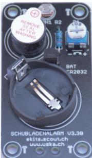
Kontrolliere nochmals alle Bauteile auf die richtige Einbaulage und ob alle Bauteile richtig eingelötet sind. Es darf nicht zuviel oder zuwenig Lötzinn haben. Zuviel Lötzinn kann einen Kurzschluss zur Folge haben und dann funktioniert dein Schubladenalarm nicht. Ist alles richtig, kannst Du die Batterie einbauen. Die Beschriftung der Batterie muss sichtbar bleiben!
