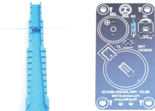
Wenn du noch nie gelötet hast, baue als erstes den Widerstand R2 ein. Dazu biegst du ihn zuerst mit der Biegelehre auf das richtige Rastermas. Die Bauteile werden von vorne durch die richtigen Löcher gesteckt und ungeschlossen wird auf der Rückseite gelötet. Die Rückseite ist jene Seite wo "Ich gehöre" und ein grosses weisses Feld aufge-druckt ist. Nach dem löten werden die überlangen Beine auf der Rückseite abgeschnitten.
